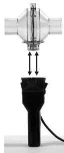
(d) Richten Sie die beiden kleinen Löcher auf der Unterseite des Durchflusskopfes an den beiden Öffnungen in der Oberseite des Griffs aus.
